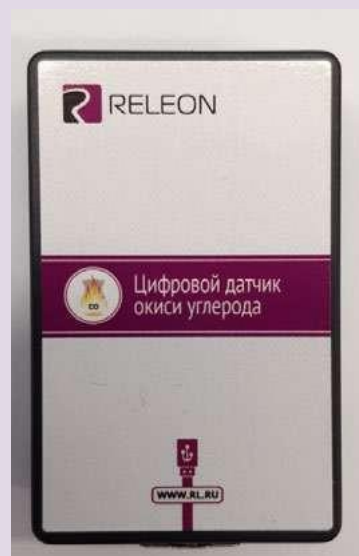
Рис. 11. Датчики кислорода (слева) и угарного газа (справа)
