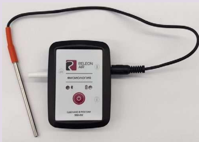
Рис. 12. Датчик температуры тела
