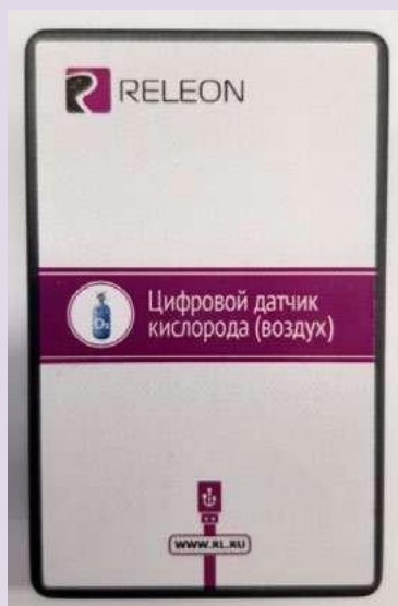
Рис. 11. Датчики кислорода (слева) и угарного газа (справа)
